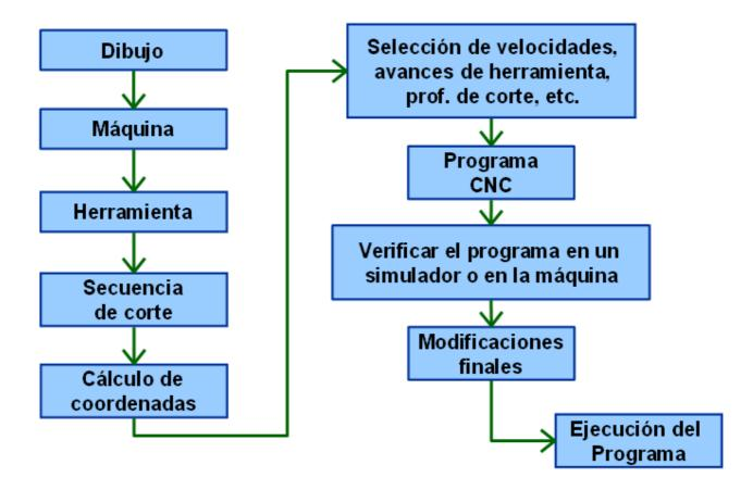
Conocidos los elementos de fabricación disponibles, la definición del proceso de mecanizado puede dividirse en las siguientes etapas:
