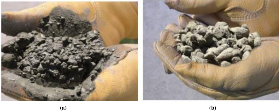
Figura 5 – Mezclas con cantidad de agua excesiva (a) e insuficiente (b) (Tennis, Leming & Akers, 2004)
