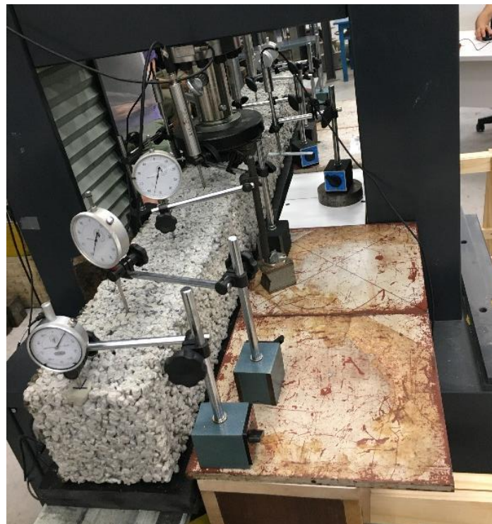
Figura 23 - Montaje experimental del ensayo viga sobre fundación elástica
