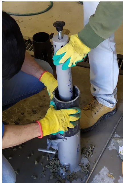
Figura 8 - Compactación de probetas cilíndricas 10 cm x 20 cm mediante el martillo de Proctor estándar.
