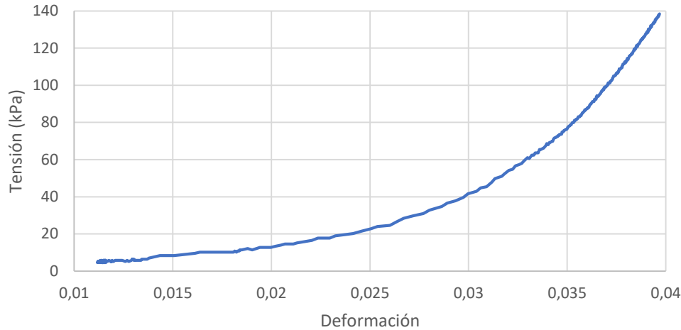
Figura 46 - Gráfica de tensión-deformación de la goma caracterizada.
