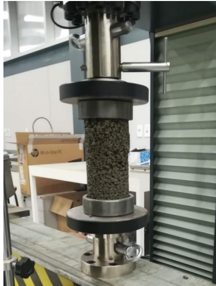
Figura 12 - Ensayo de compresión para probetas normalizadas de 10 cm x 20 cm.
