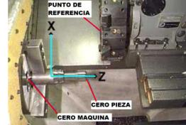
Los puntos cero máquina M y referencias máquinas R son fijos. En ocasiones la posición física de R se identifica con unos micro-ruptores, lo que permite controlar el sistema de medición y precisión de los captores al comparar los valores medidos en el control con los teóricos.
