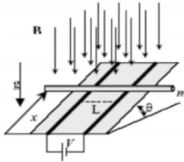
En primer lugar, observamos que la fuente de corriente, los segmentos de los rieles que van desde la base de la rampa hasta la posición  $x$ , y la parte de la barra que está entre los rieles, forman un circuito cerrado. Este circuito consta de  $V$  y dos resistencias en serie, que son los dos tramos de riel. Recordamos que la resistencia de un cilindro de resistividad  $\rho$ , área transversal  $A$ , y longitud  $\ell$ , es
