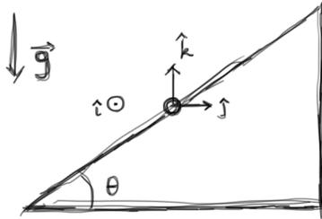
Además de la fuerza magnética, sobre la barra actúan el peso y la normal. Descomponemos la normal en las direcciones  $\hat{k}$  y  $\hat{j}$ , para luego plantear la condición de equilibrio en cada una de estas direcciones.
