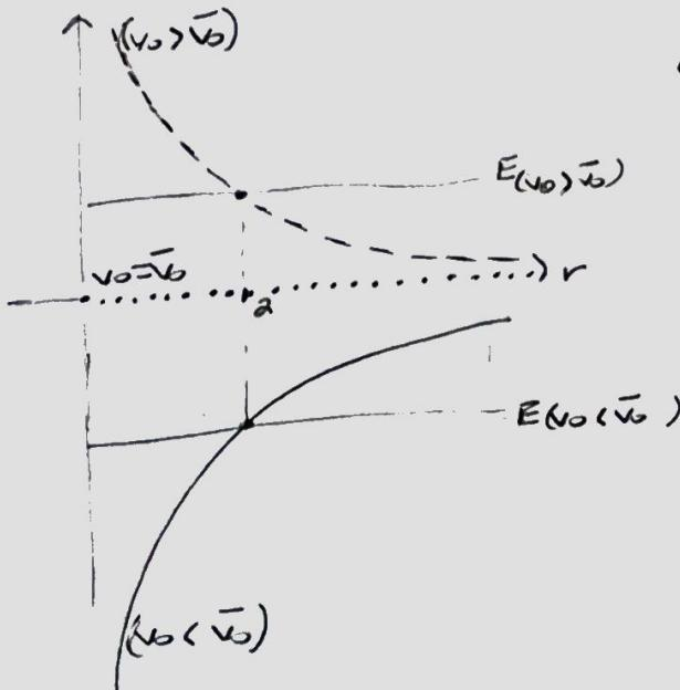
← El potencial efectivo  $U_{\text{eff}}(r)$  sigue un tipo de curva según sea  $v_0$ , la energía también se modifica de acuerdo a  $v_0$ .
