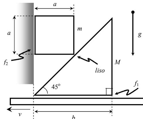
encuentra apoyada sobre la pared (contacto distribuido) y un punto de la hipotenusa de la placa rectangular. El contacto entre las placas es liso, y el entre la placa cuadrada y la pared es rugoso con coeficiente de rozamiento (estático y dinámico)  $f_2$ . Todo el sistema se encuentra en un mismo plano vertical. Se verifica que  $b = 2a$  y  $M = 2m$ . Inicialmente las placas están en reposo.
