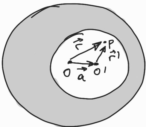
El campo total en el punto P será la suma vectorial del campo eléctrico debido al cilindro homogéneo de carga volumétrica  $\rho_0$  y del campo eléctrico debido a un cilindro homogéneo de carga volumétrica  $-\rho_0$  en el lugar de la cavidad.
