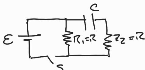
b.i) capacitor inicialmente descargado, inmediatamente después de cerrar la llave la diferencia de potencial a través del capacitor es cero (actúa como cortocircuito, es como un cable ideal)
