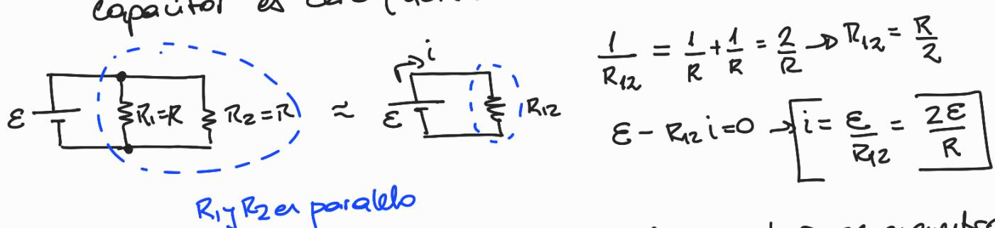
b.ii) luego de un tiempo muy largo, el capacitor se encuentra completamente cargado y deja de circular corriente por la rama donde está (actúa como circuito abierto)
