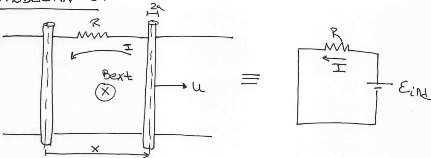
$$\phi = B_{ext} \cdot D \cdot (x(t) - 2a) + \phi \text{ autoinducido}$$
