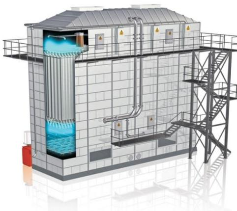
Figura 8-19: Precipitador eletrostático úmido (<http://www.bernauer.com.br>)
