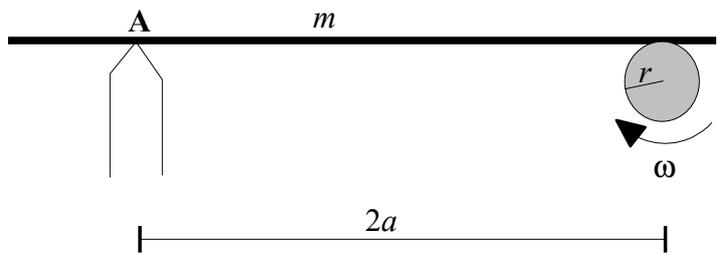
a) Inicialmente se coloca la barra en reposo, con su centro de masa a una distancia  $x_0$  de **A**. Halle los valores de  $x_0$  para los cuales la barra permanece en reposo.
