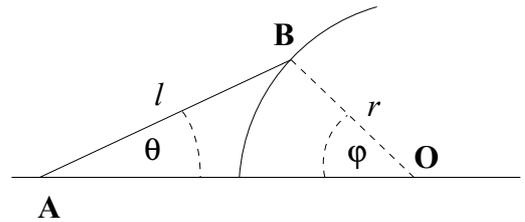
a) Halle todas las reacciones que actúan sobre la barra en función de los ángulos indicados en la figura y el peso de la barra.
